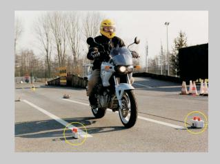
SPEED MEASUREMENT BEFORE STARTING THE EVASION TEST
